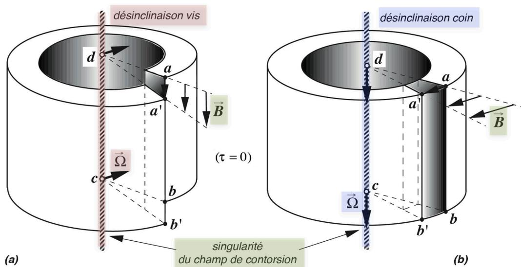
**Figure 2.8** - Réalisation de désinclinaisons vis (a) et coin (b) par découpage et recollage
