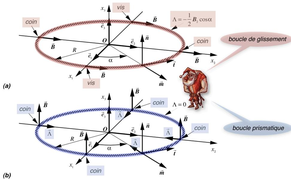
**Figure 2.28** - Boucle de dislocation de glissement (a) et boucle de dislocation prismatique (b)
