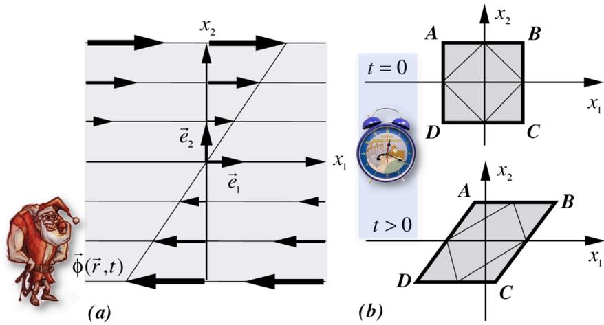
Figure 1.8 - Cisaillement pur du milieu
