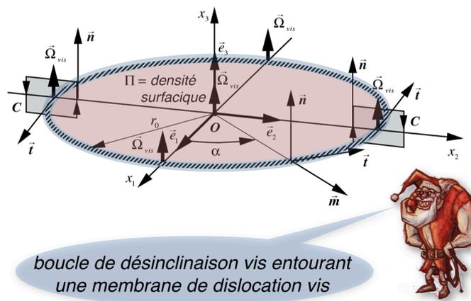
Figure 2.30 - boucle de désinclinaison vis avec sa membrane chargée
