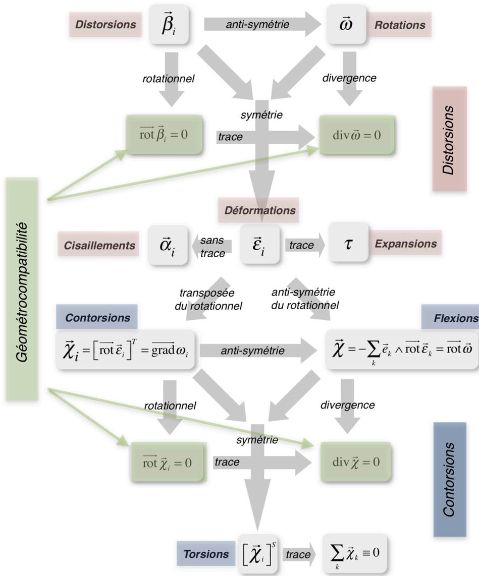
Figure 1.16 - Le système complet des distorsions et des contorsions d'un solide
