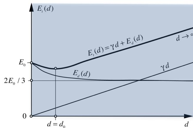
**Figure 2.16** - Énergie totale de deux dislocations partielles en fonction de la distance les séparant, source d'une «force forte» d'attraction entre elles
