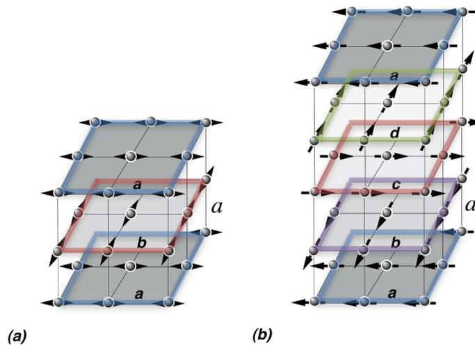
**Figure 2.25** - Réseaux cubique présentant une symétrie axiale, simple dans le cas **(a)**, et orientée de type dextrogyre (*right-handed*) en **(b)**
