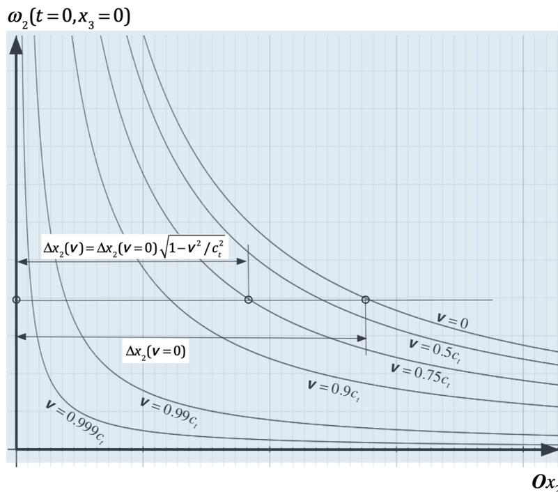
**Figure 6.2** - Contraction de la composante  $\omega_2(t=0, x_3=0)$  du vecteur de rotation d'une dislocation vis dans  $Ox_1x_2x_3$  dans la direction de son mouvement, en fonction de sa vitesse  $\vec{v}$
