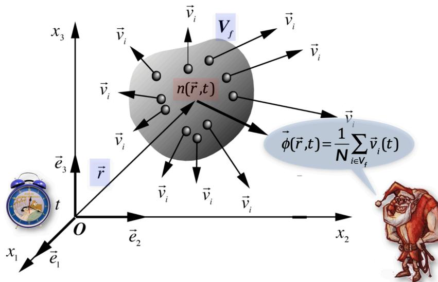
Figure 1.5 - Vitesse et densité locales moyennes d'un milieu
