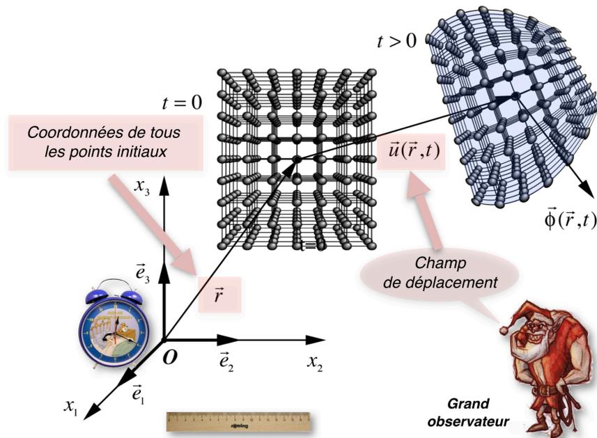
Figure 1.1 - Les coordonnées de Lagrange
