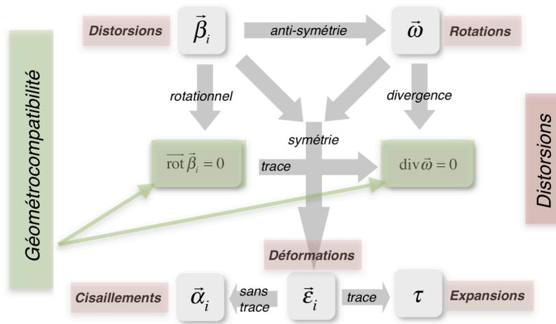
Figure 1.13 - Le système complet des distorsions d'un réseau solide
