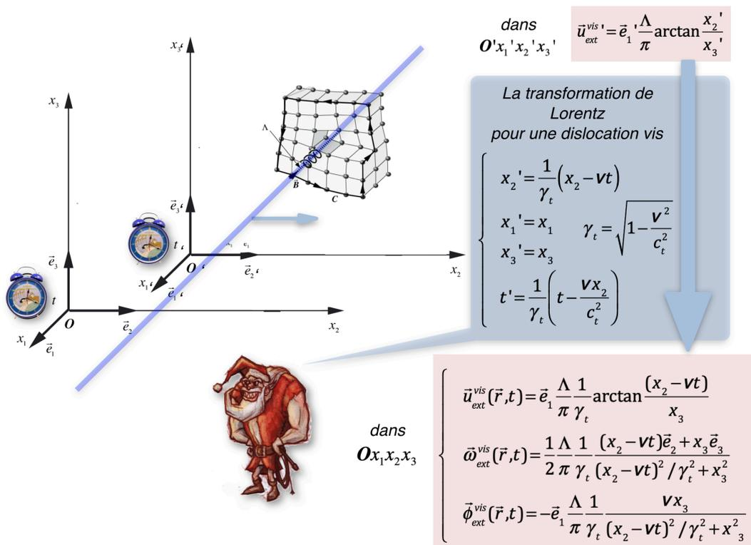
**Figure 6.1** - La transformation de Lorentz déduite à l'aide d'une dislocation vis en mouvement
