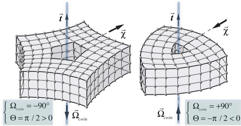
**Figure 2.21** - Exemples de désinclinaisons coins quantifiées  $\Omega = \mp 90^\circ$  sur un réseau cubique simple.
