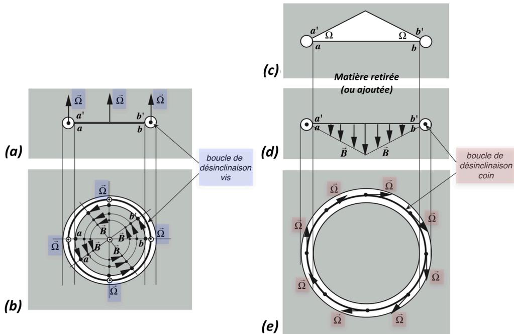
**Figure 2.9** - Réalisation d'une boucle de désinclinaison vis par rotation des mâchoires (a) et (b) et d'une boucle de désinclinaison coin par retrait (ou ajout) d'un morceau de milieu de forme conique (c), (d) et (e)
