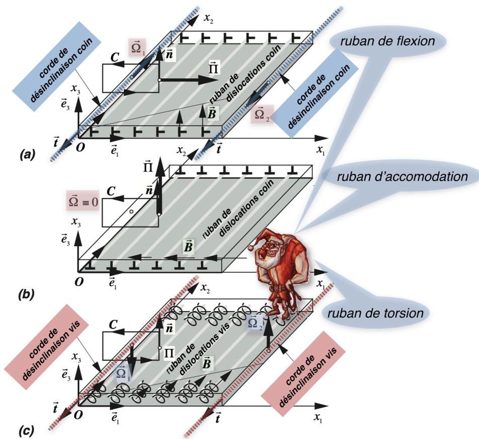
**Figure 2.19** - Rubans de dislocations bordés de lignes de désinclinaison de type coin (a) et de type vis (c).
