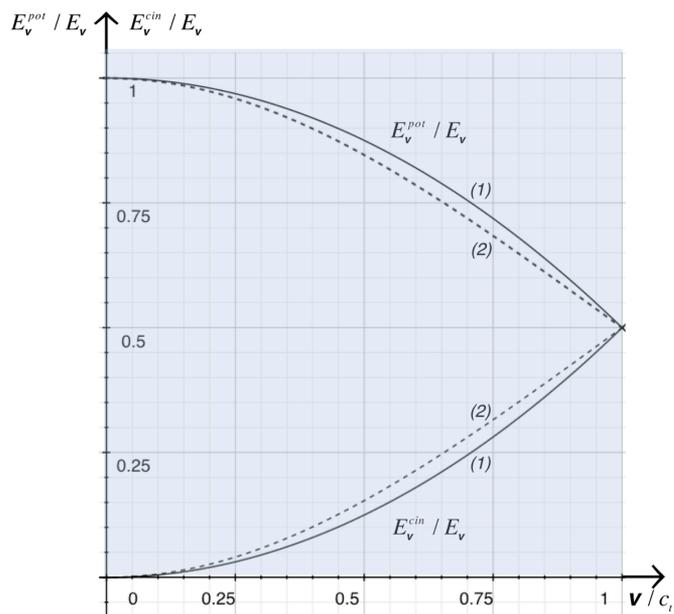
**Figure 6.6** - fractions de l'énergie totale sous forme potentielle et cinétique, en fonction de la valeur de  $v/c$ , dans le cas d'une dislocation vis ou coin (1) ou d'une charge sphérique de rotation (2)
