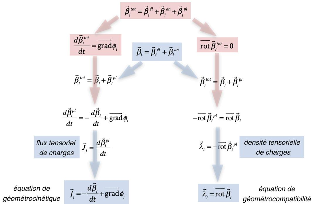
**Figure 2.5(a)** - Introduction de la densité et du flux tensoriels de charges plastiques en présence d'élasticité, d'anélasticité et de plasticité
