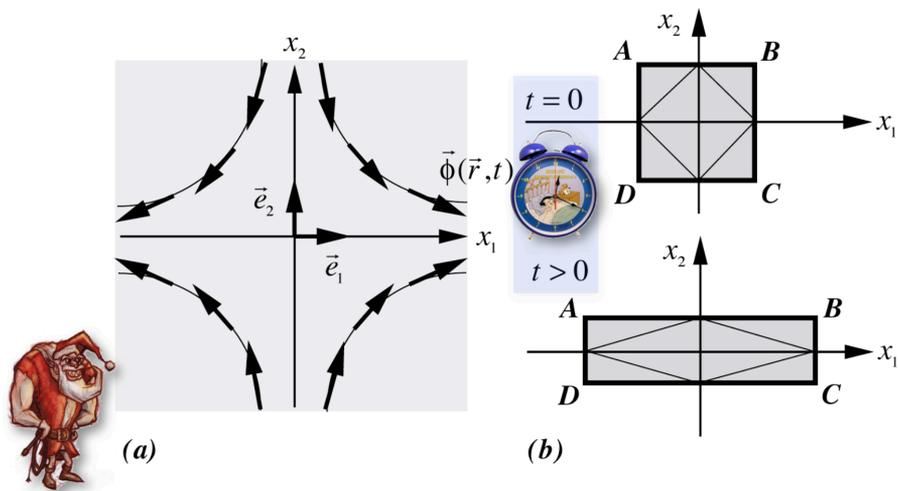
Figure 1.9 - Allongement à expansion volumique nulle
