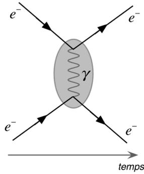
**Figure 13.2** - Diagramme de Feynman de l'interaction entre deux électrons via un photon
