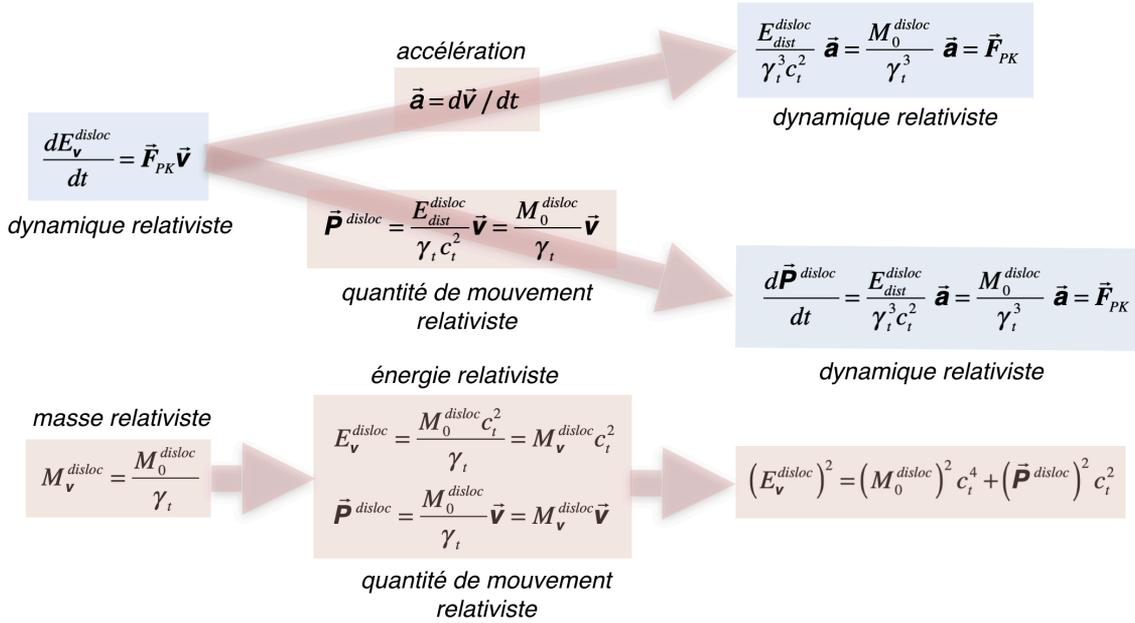
**Figure 6.7** - équation dynamique relativiste, quantité de mouvement relativiste et masse relativiste d'une dislocation vis ou coin
