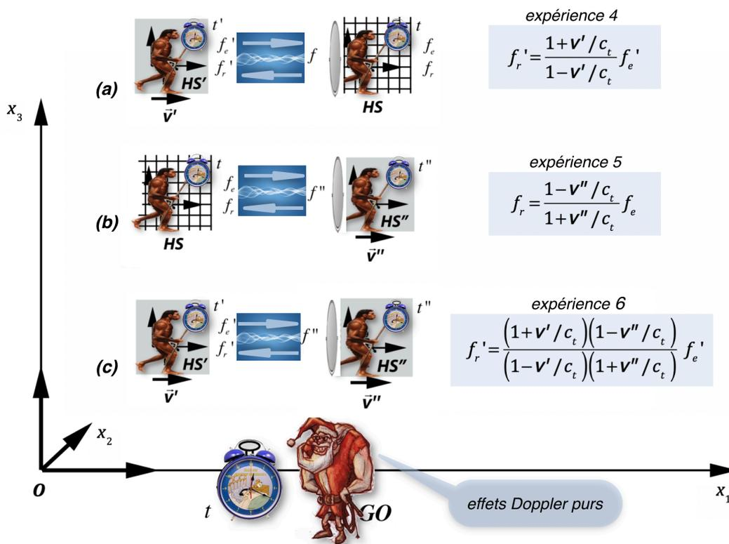
Figure 6.13 - Différentes configurations de mesure de l'effet Doppler pur
