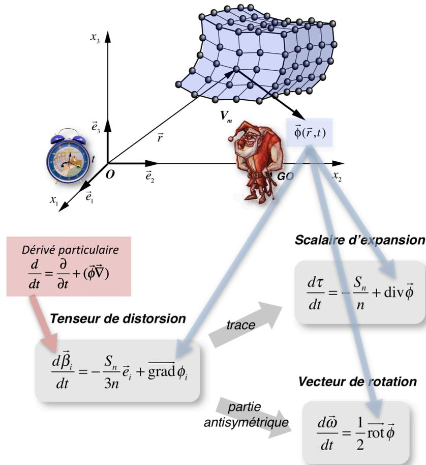
Figure 1.12 - Les équations géométrocinétiques
