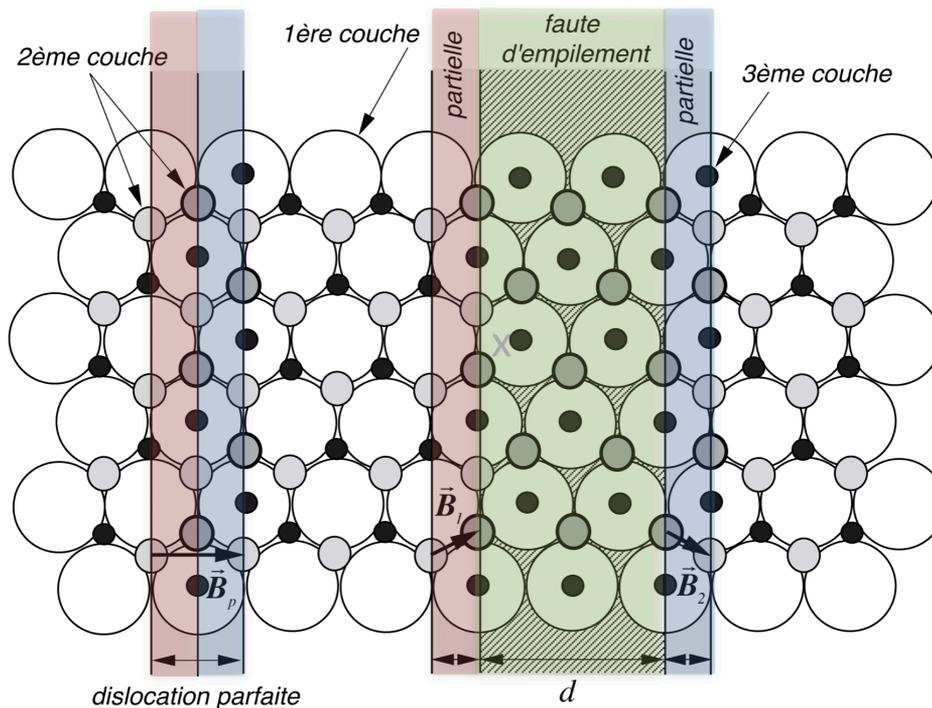
**Figure 2.15** - Dissociation d'une dislocation parfaite en deux partielles et ruban de faute d'empilement dans un un réseau cubique à faces centrées
