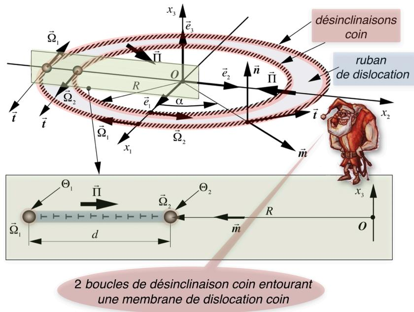
**Figure 2.31** - boucle de doublet de désinclinaisons coin liées par un ruban de dislocation
