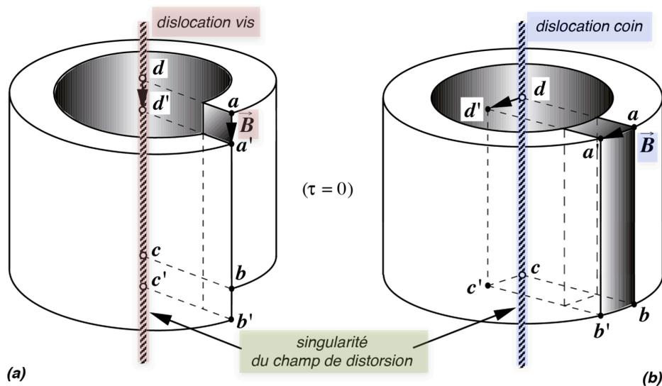
Figure 2.2 - Réalisation de dislocations vis (a) et coin (b) par découpage et recollage
