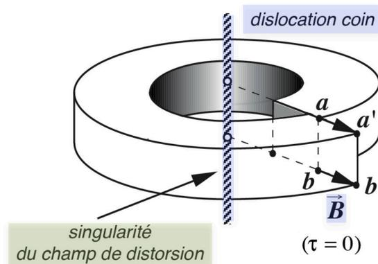
**Figure 2.3** - Autre réalisation d'une dislocation coin par découpage et recollage
