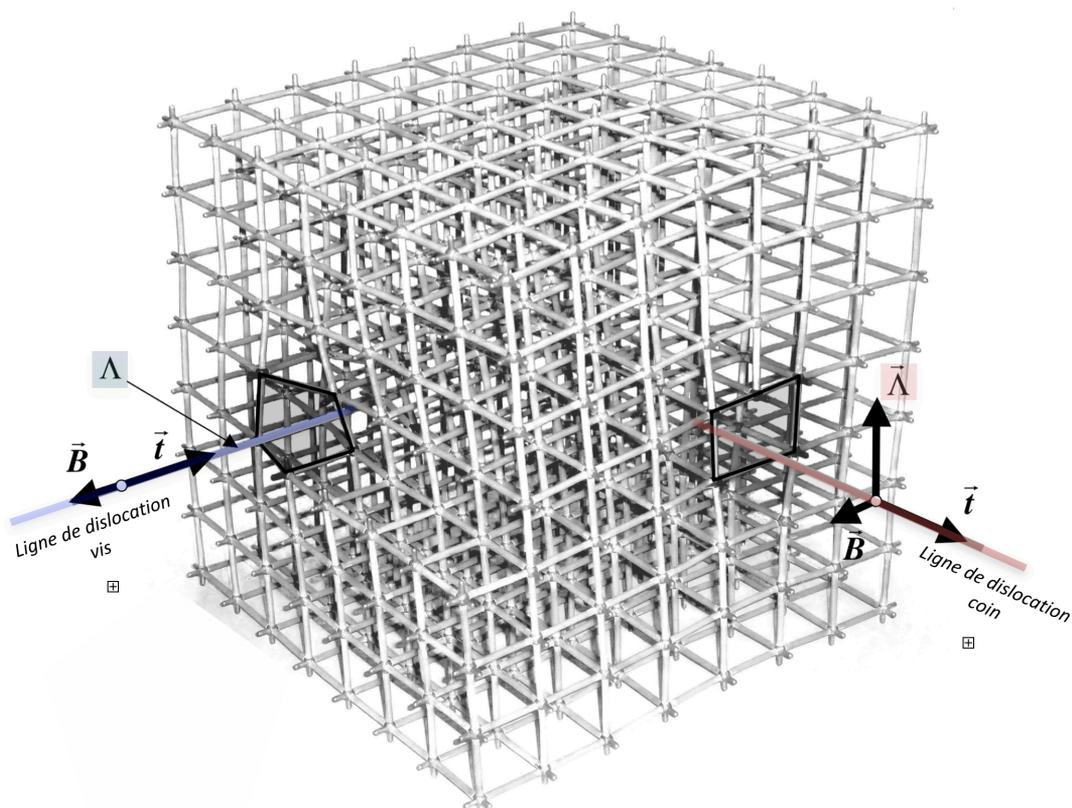
**Figure 2.14** - Dislocation passant de type vis à type coin dans un réseau cubique
