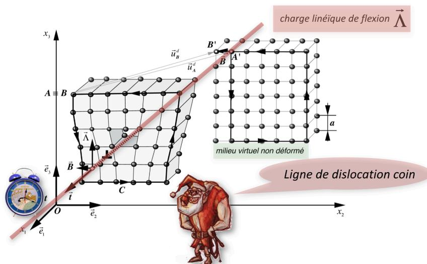
**Figure 2.11** - Ligne de dislocation de type coin quantifiée dans un réseau cubique
