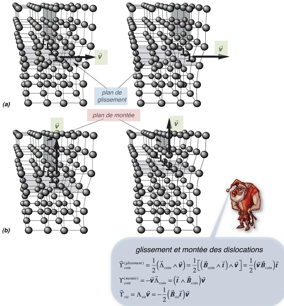
**Figure 2.36** - Les mouvements de glissement (a) et de montée (b) d'une dislocation coin
