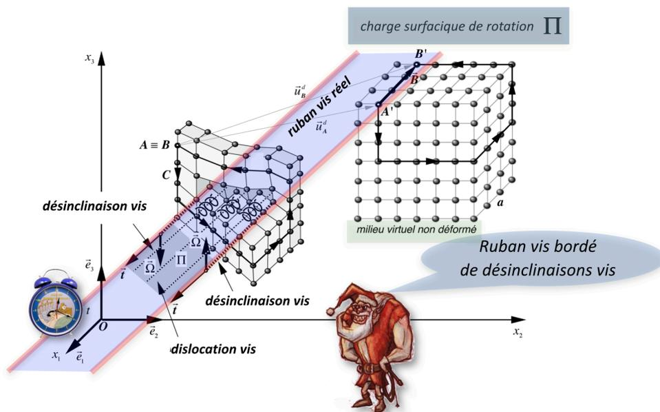
**Figure 2.20 - Ruban de dislocation bidimensionnel quantifié composé de trois dislocations de réseau de type vis**
