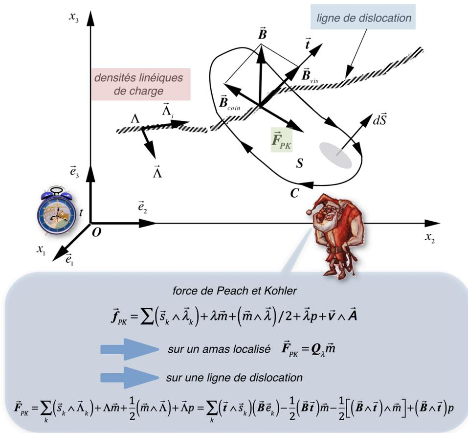
**Figure 2.38** - La force de Peach et Koehler  $\vec{F}_{PK}$  agissant sur les singularités topologiques
