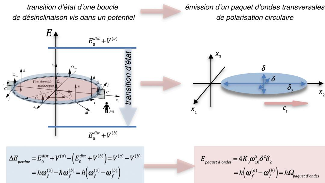
**Figure 14.2 - Emission d'un paquet d'ondes transversales de polarisation circulaire par la transition d'état d'une boucle dans un potentiel**
