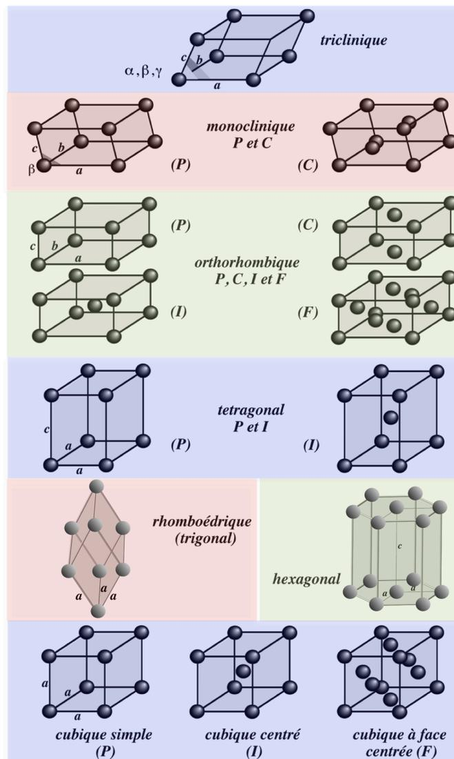
**Figure 1.4** - Les sept systèmes cristallins et les quatorze réseaux de Bravais
