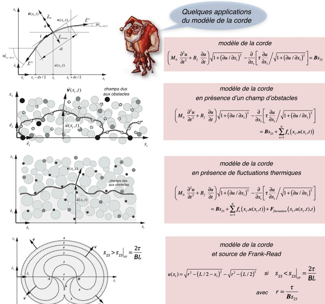
Figure 2.40 - Le modèle de la corde et quelques unes de ses applications
