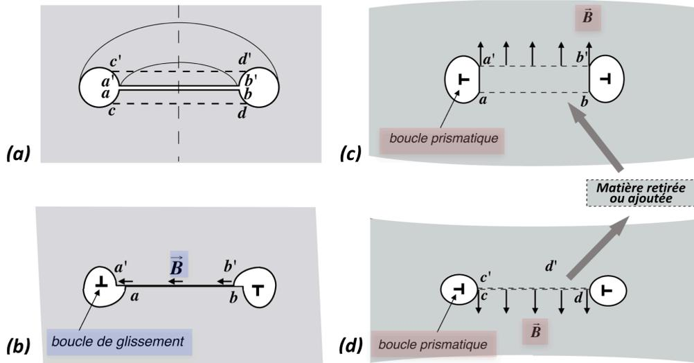
**Figure 2.4** - Découpage initial d'un tore et de son plan médian pour former des boucles (a) et réalisation d'une boucle de dislocation par glissement des mâchoires (b) et de boucles prismatiques de dislocation par addition (c) ou soustraction (d) de milieu.
