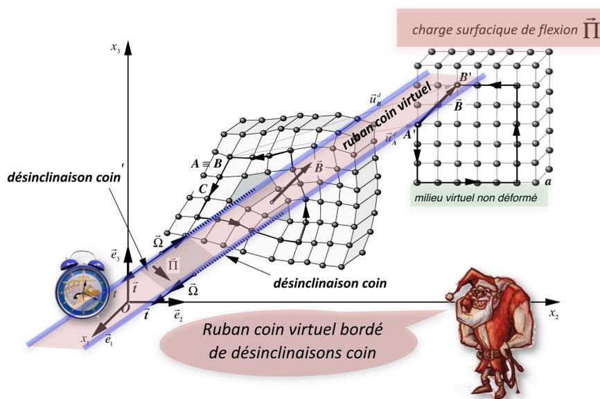
Figure 2.23 - Doublet de désinclinaisons quantifiées de type coin avec ruban de dislocation virtuel
