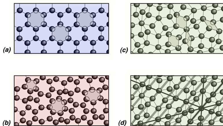
**Figure 1.3** - Réseaux bidimensionnels cristallin (a), amorphe (b) et quasi-cristallin (c) et (d)
