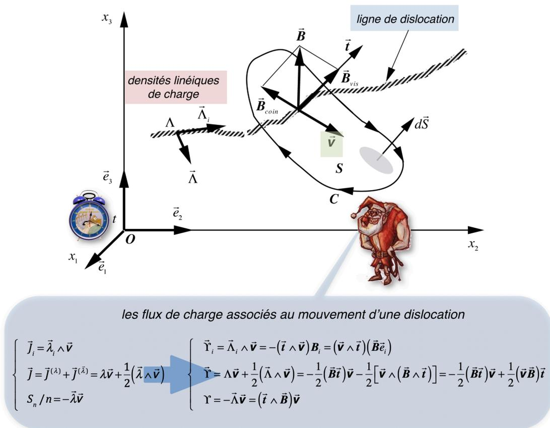
**Figure 2.35** - Les flux de charge associés à une ligne de dislocation se déplaçant à vitesse  $\vec{v}$  dans le référentiel  $Ox_1x_2x_3$
