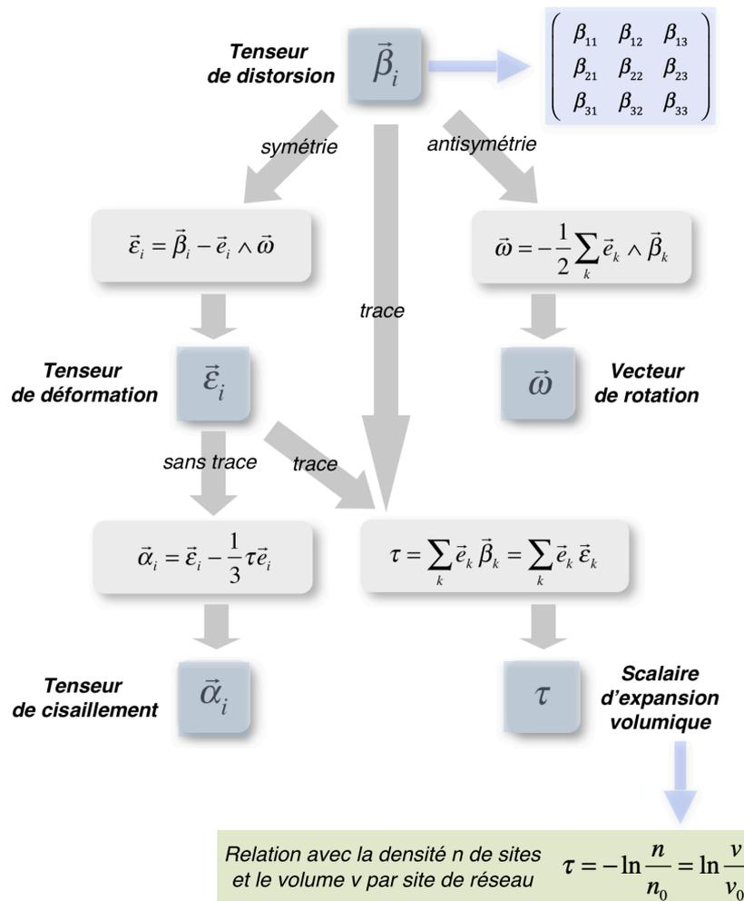
Figure 1.11 - Les décompositions du tenseur de distorsion
