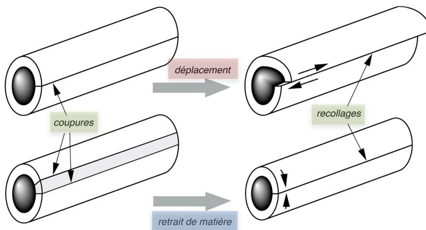
Figure 2.1 - Les fameux «tuyaux de Volterra»
