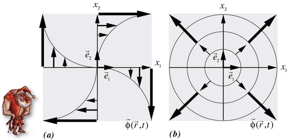
Figure 1.10 - Rotations locales (a) et expansions (b) non-uniformes du milieu
