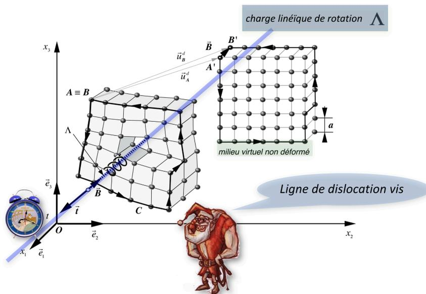
**Figure 2.10** - Ligne de dislocation de type vis quantifiée dans un réseau cubique
