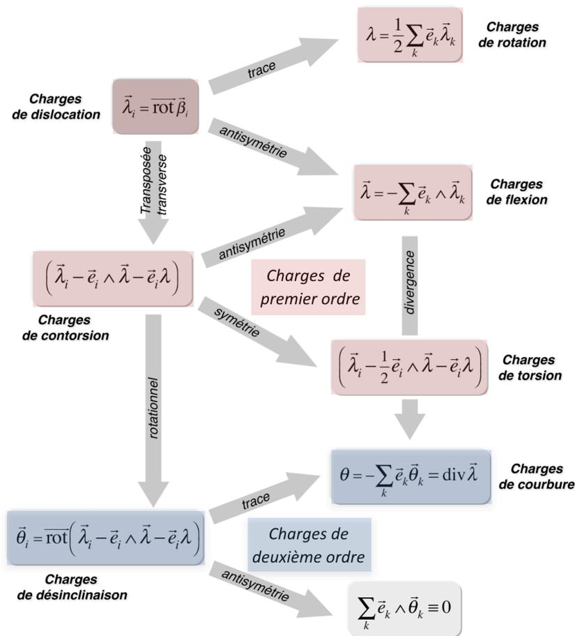
**Figure 2.7** - Déduction de l'ensemble des densités de charge à partir de la densité de charge de dislocation
