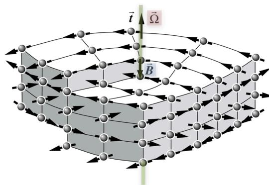
**Figure 2.26** - Dispiration de  $+90^\circ$  introduite dans le milieu axial de la figure 2.25 (b) montrant bien la nécessité d'ajouter un vecteur de translation  $\vec{B}$  pour assurer la continuité axiale
