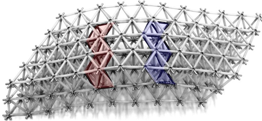
**Figure 2.17** - Modèle d'une dislocation mixte dans un réseau cubique à faces centrées, présentant une dissociation en deux partielles, ainsi que des décrochements sur les partielles
