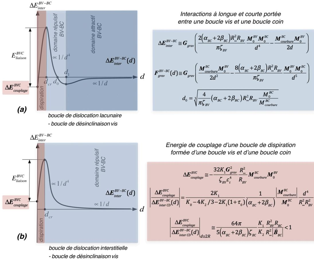
**Figure 9.2 - Potentiels d'interaction (de capture) entre une boucle de dislocation coin BC lacunaire (a) ou interstitielle (b) et une boucle de désinclinaison vis BV pour former une dispiration coin-vis BVC**
