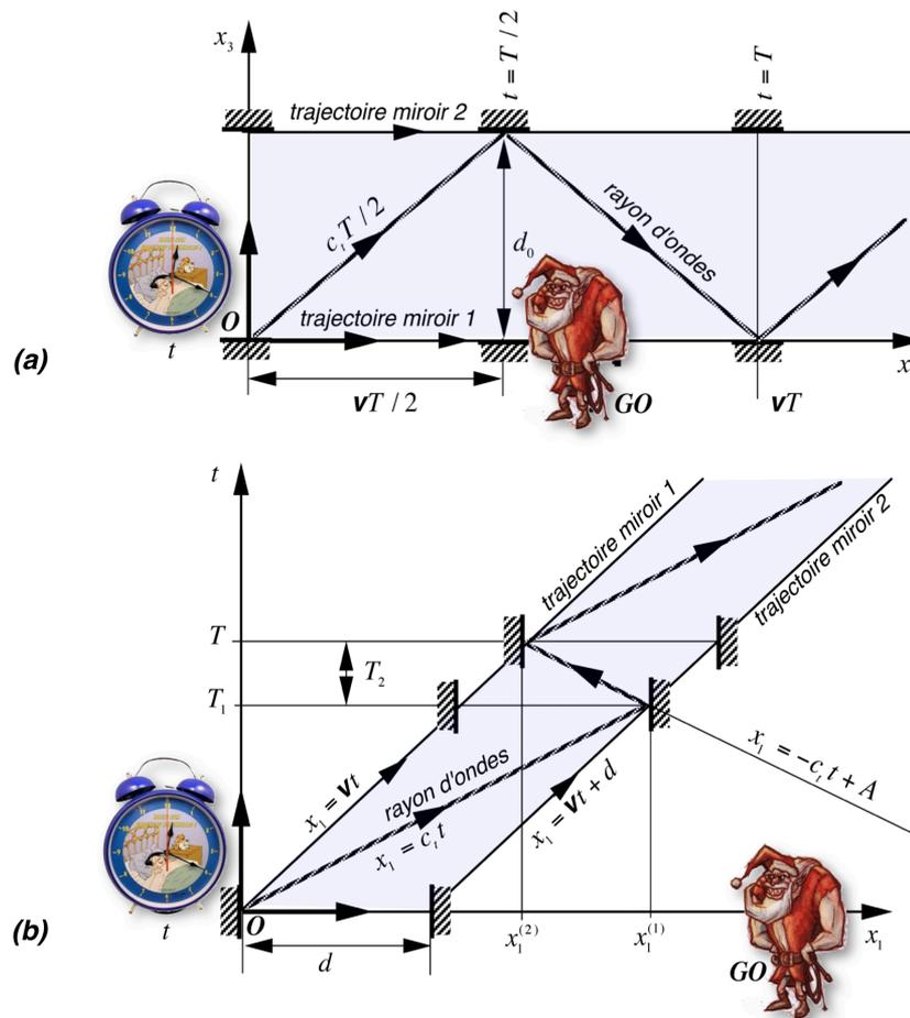
**Figure 6.3 - (a)** la trajectoire de l'onde transversale émise verticalement par l'horloge locale de l'«objet» mobile dans le référentiel, telle qu'observée par le **GO** dans son référentiel
