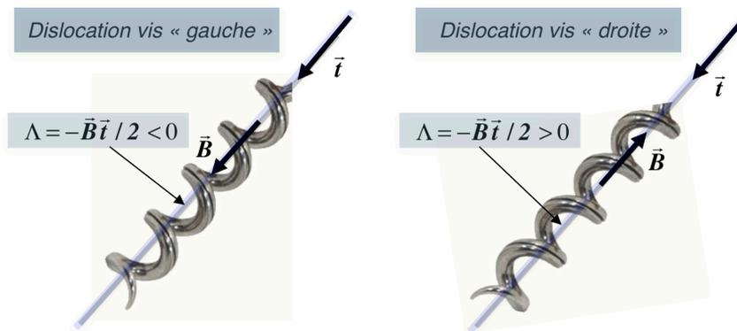
Figure 2.12 - Vecteurs de Burgers de dislocations de type vis, «gauche» et «droite» respectivement
