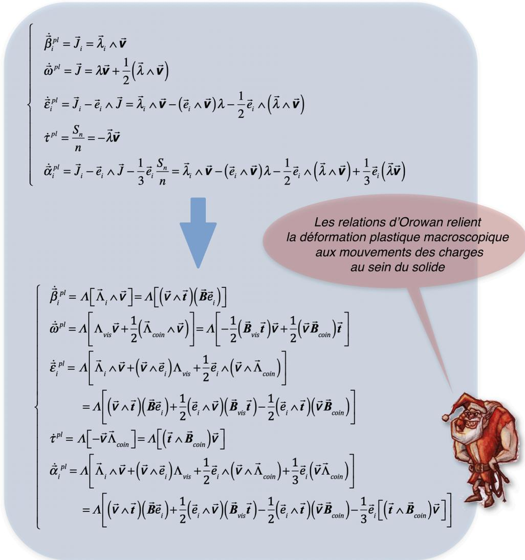
**Figure 2.37** - Les relations d'Orowan qui relient les distorsions plastiques au mouvement des charges
