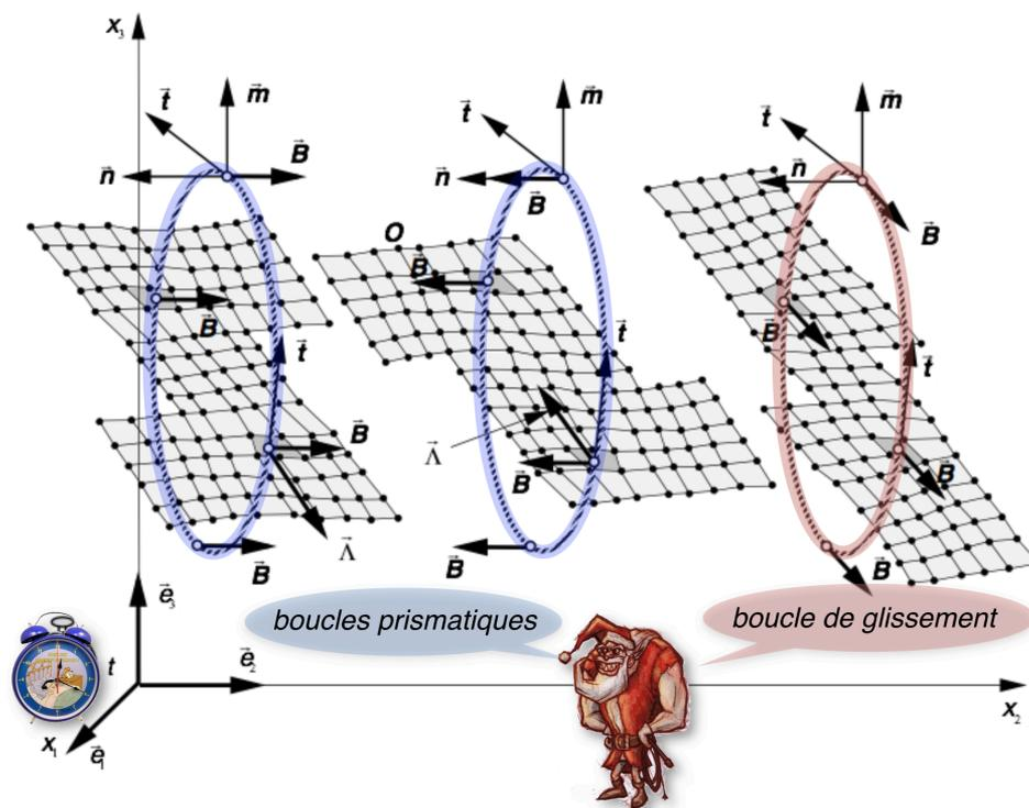
**Figure 2.29** - Quantification des boucles de dislocations sur un réseau
