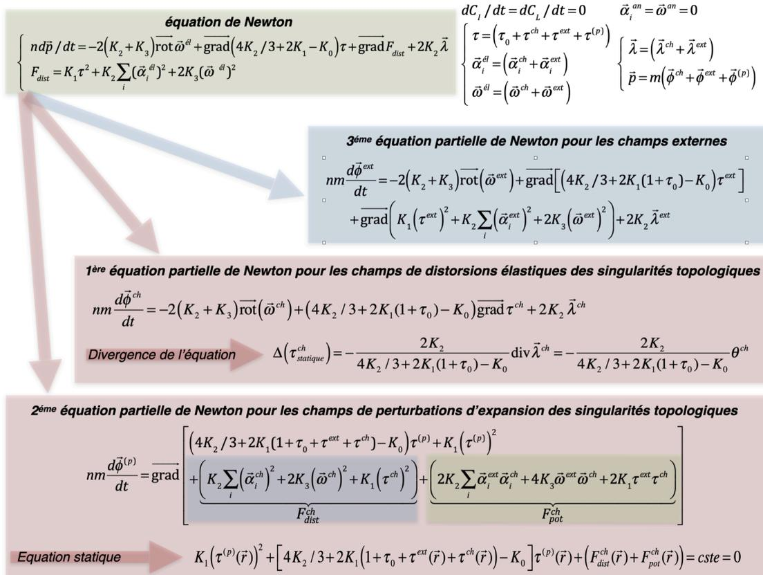
**Figure 5.1** - Séparabilité de l'équation de Newton en trois équations partielles en présence de singularités topologiques
