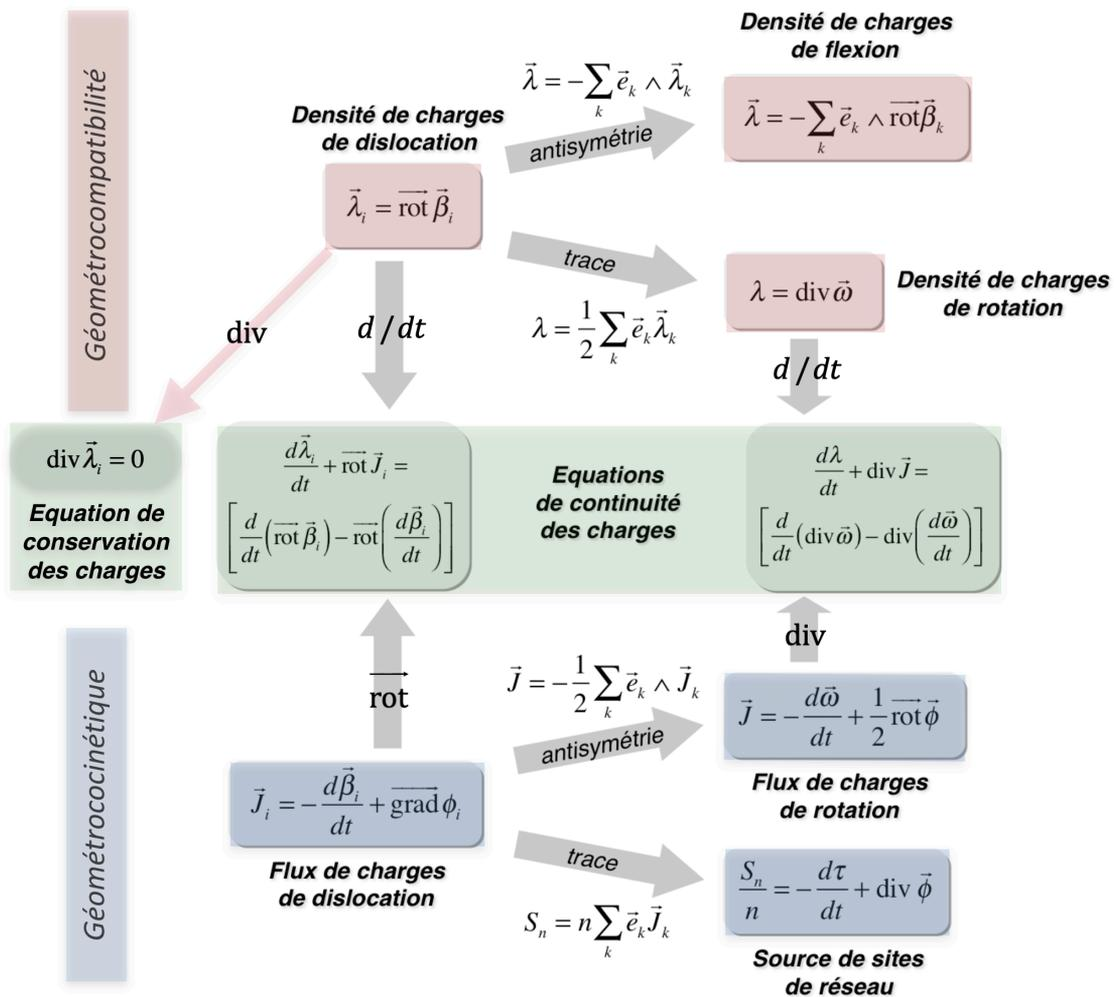
Figure 2.5(b) - Décompositions des densités et des flux de charges et équations de continuité et de conservation des charges
